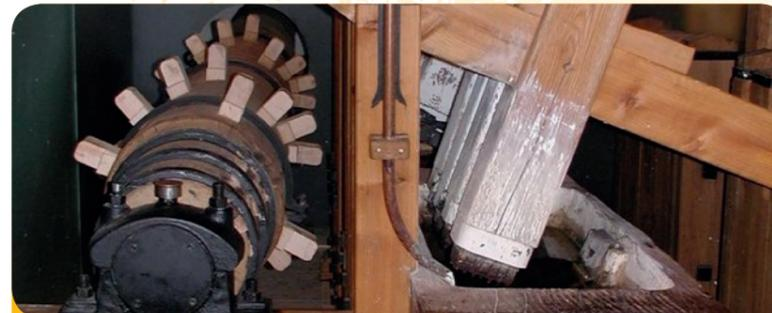
Abb. 4: So ein „Stampfwerk“ wurde früher bei der Papierherstellung benutzt. Wozu? Im Text steht die Antwort.
